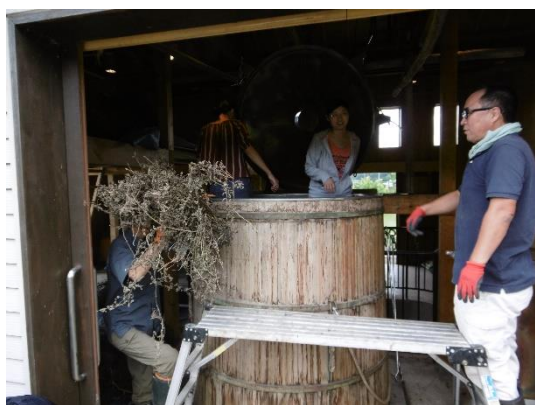
写真 5-5 ハッカ草を蒸留釜へ入れる作業
